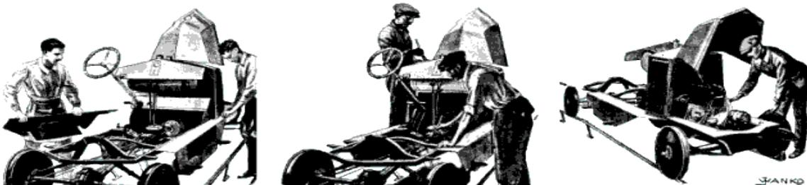
12. Sur les longerons de droite et de gauche, on fixe un coffre en tôle, qui fait corps avec le châssis et reçoit l'outillage et la batterie
