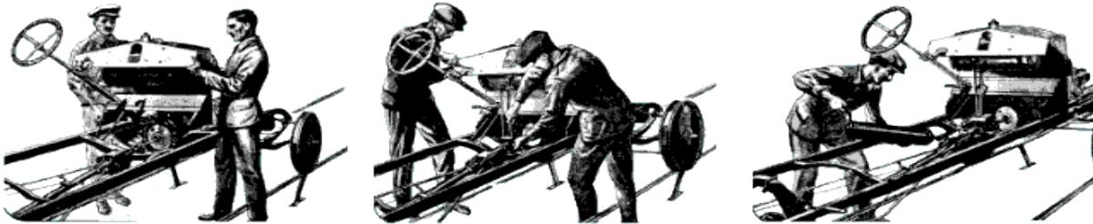
4. Deux ouvriers mettent en place la planche-support des appareils électriques, à laquelle par des brides est fixé le réservoir d'essence.
